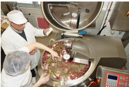
An der Hochschule Anhalt werden die fleischtechnologischen Prozesse erforscht. Dabei ist das Kuttern, also das Zerkleinern und Vermischen der Zutaten, eine wesentliche Voraussetzung für die Wurstherstellung, hier mit dem Projektleiter an der Hochschule Anhalt, Prof. Dr. Wolfram Schnäckel.
